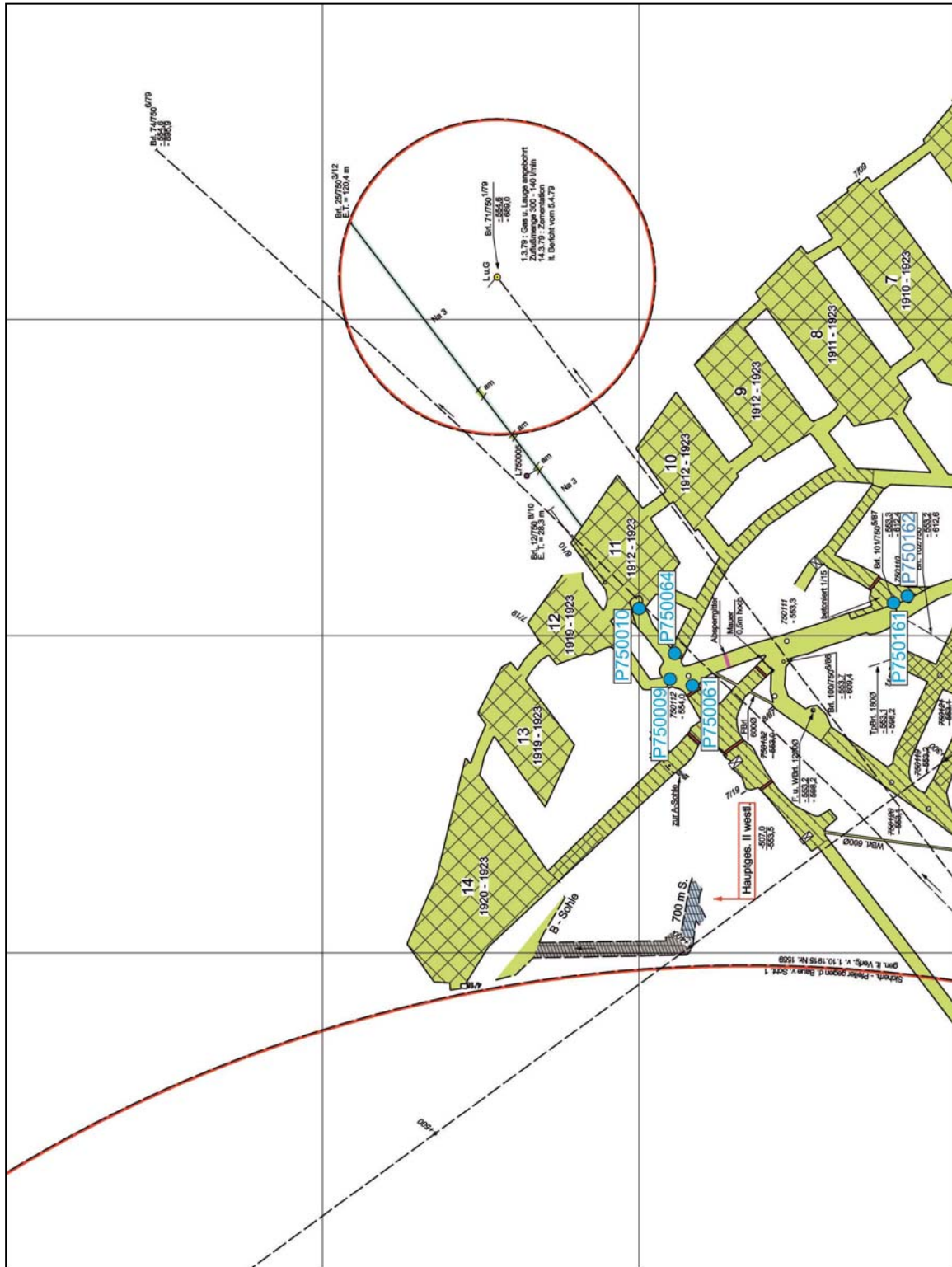
Abb. 2 Lösungsfassungsstellen (blau markiert) auf der 750-m-Sohle im Bereich des Carnallitbaufeldes (nördlicher Bereich) (verändert nach Risswerk, Stand 2015).
